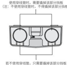
③将监控摄像机的DC电源线与稳压电源DC接口连接，将AC电源线与接线端子相连接，同时可将网线收纳入盒，通过螺丝将壳体固定。
